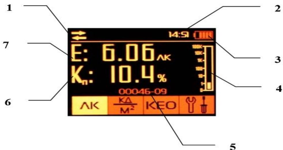
Рис. 4.3. Режим измерения освещенности и коэффициента пульсации
