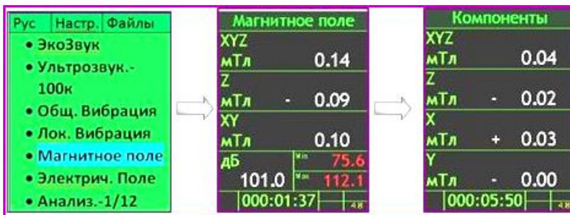
Рис. 6.2. Дисплей индикаторный блок ЭКОФИЗИКА-D для измерения электромагнитных излучений
