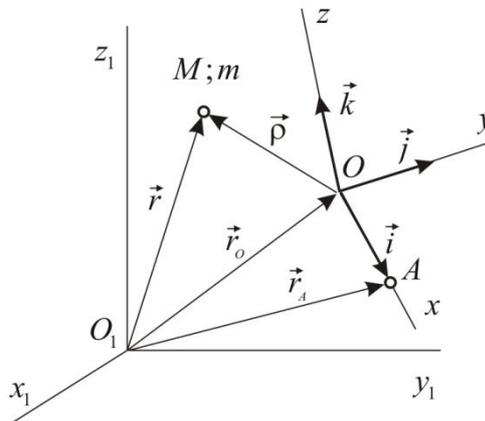
Рис. 11.2. Движение точки  $M$  относительно подвижной СК, которая движется относительно неподвижной СК
