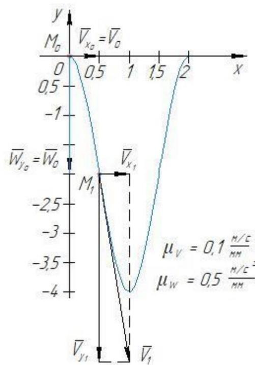
Рис. 11.7. Направления скоростей и ускорений точки при сложном ее движении
