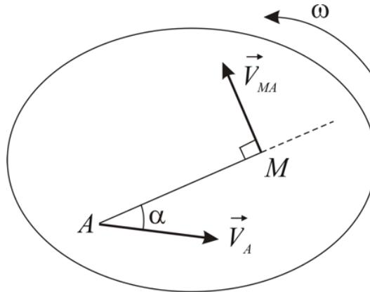
Рис. 10.3. линейные скорости двух точек при плоскопараллельном движении твердого тела
