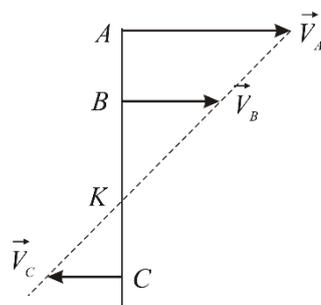
Рис. 10.6. Построение МЦС в случае, когда скорости двух точек плоской фигуры параллельны и перпендикулярны  $AB$
