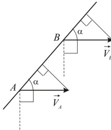
Рис. 10.5. Построение МЦС в случае, когда скорости двух точек плоской фигуры параллельны, но не перпендикулярны  $AB$
