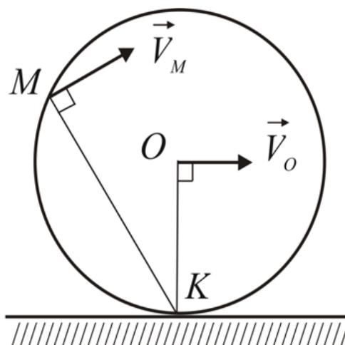
Рис. 10.7. Плоскопараллельное движение колеса
