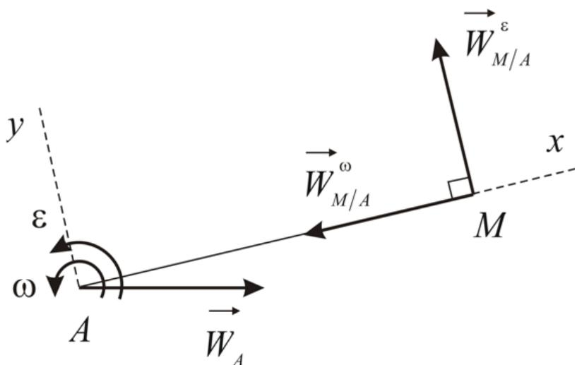
Рис. 10.8. Определение полного ускорения точки  $M$
