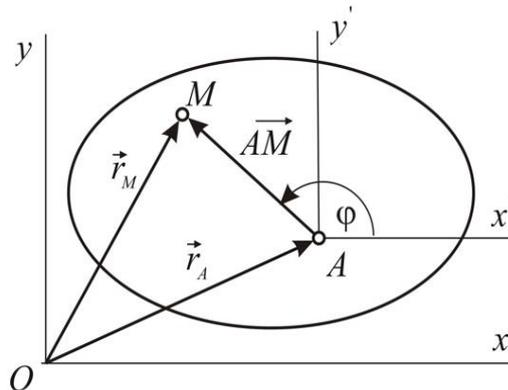
Рис. 10.2. Движение точки  $M$  вокруг полюса  $A$
