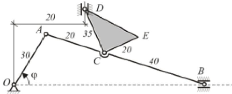
Рис. 10.9. механизм, движущийся плоскопараллельно
