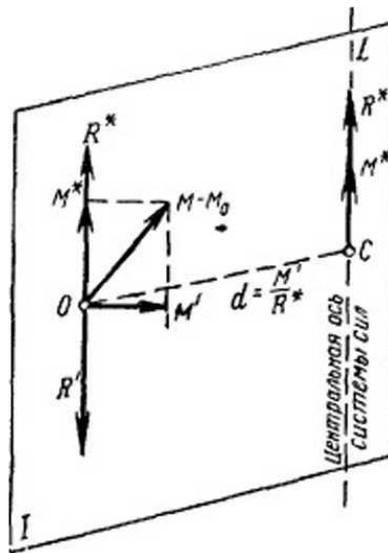
Рис.3.7. Приведение произвольной пространственной системы сил к главному вектору и главному моменту, которые перпендикулярны
