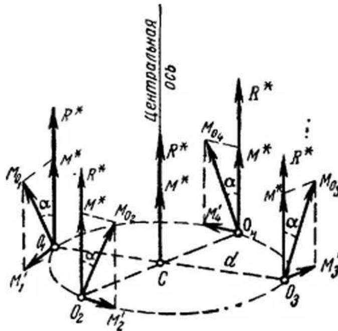
Рис. 3.9. Приведение произвольной пространственной системы сил к динаме
