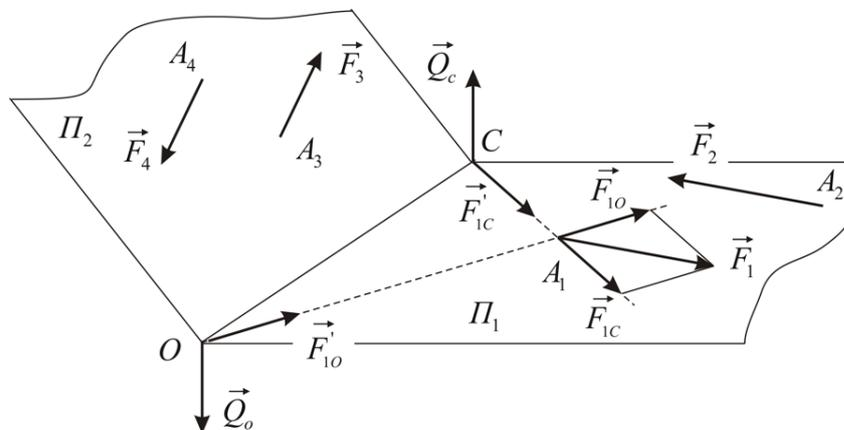
Рис. 3.3. Сложение пар сил, расположенных в пересекающихся плоскостях
