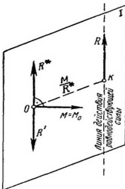
Рис. 3.5. Различие между равнодействующей силой  $R$  и силой  $R^*$ , полученной при приведении сил к центру  $O$ .
