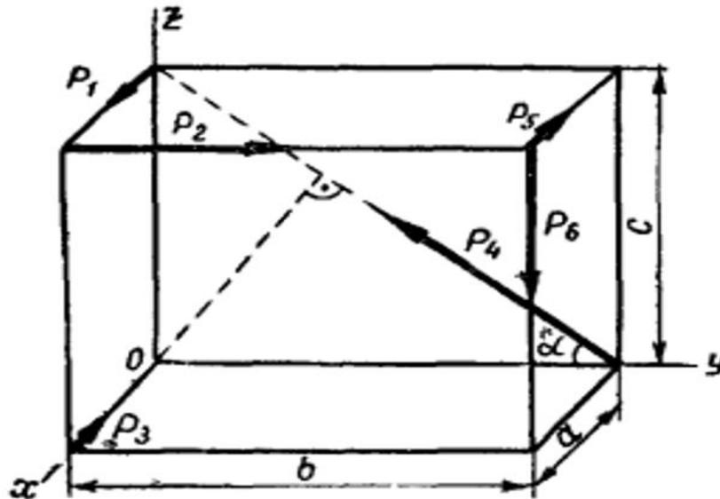
Рис. 3.10. Система пространственных сил, расположенных на прямоугольном параллелепипеде
