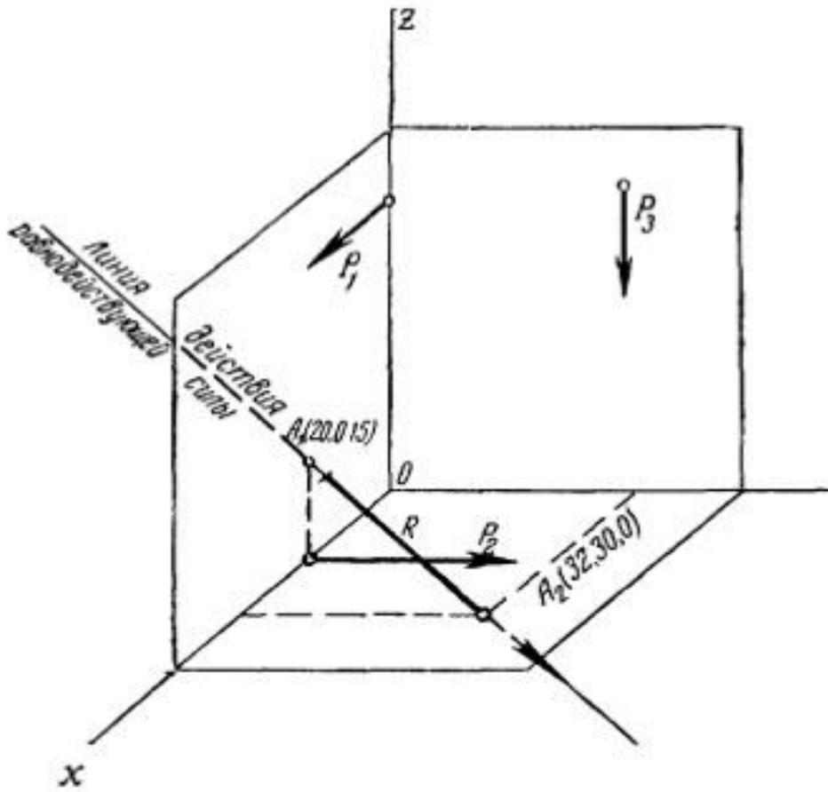
Рис. 3.12. Линия действия равнодействующей силы
