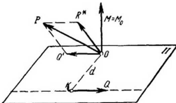
Рис 3.6. Приведение системы сил к двум скрещивающимся силам
