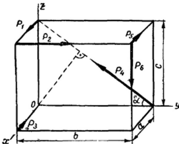
Рис 3.13. Силы, действующие на прямоугольный параллелепипед
