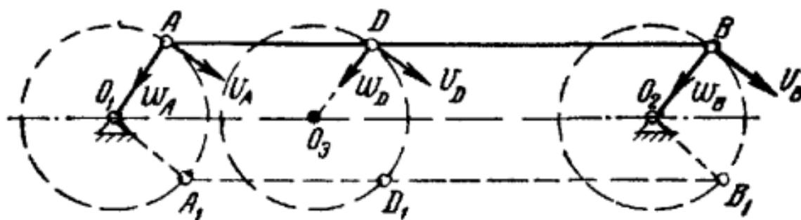
Рис. 9.3. Пример поступательно движущегося тела. Движение спарника
