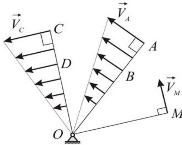
Рис. 9.7. Распределение скоростей точек при вращении твердого тела, перпендикулярного оси вращения
