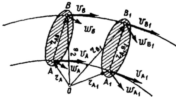
Рис. 9.2. Поступательное движение твёрдого тела
