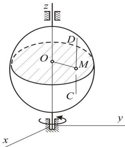
Рис. 9.4. Вращательное движение твердого тела
