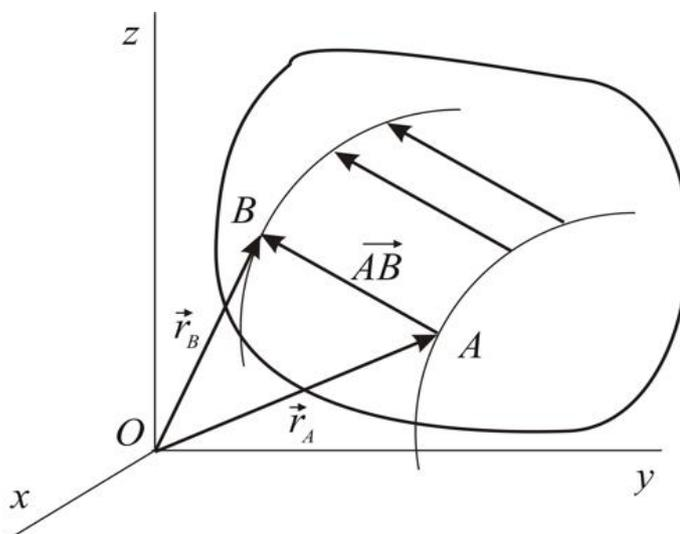
Рис. 9.1. Положение точки  $B$  относительно неподвижного центра  $O$
