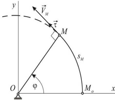
Рис. 9.6. Вычисление линейной скорости точки при вращении тела
