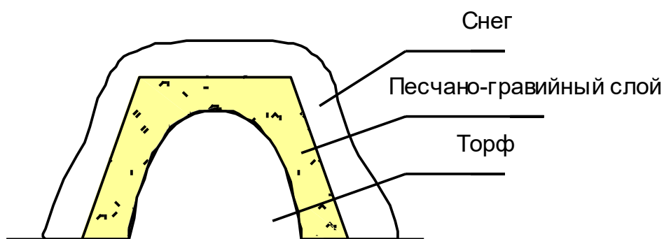
Рис. 4.21. Наземная в валике на естественном основании
