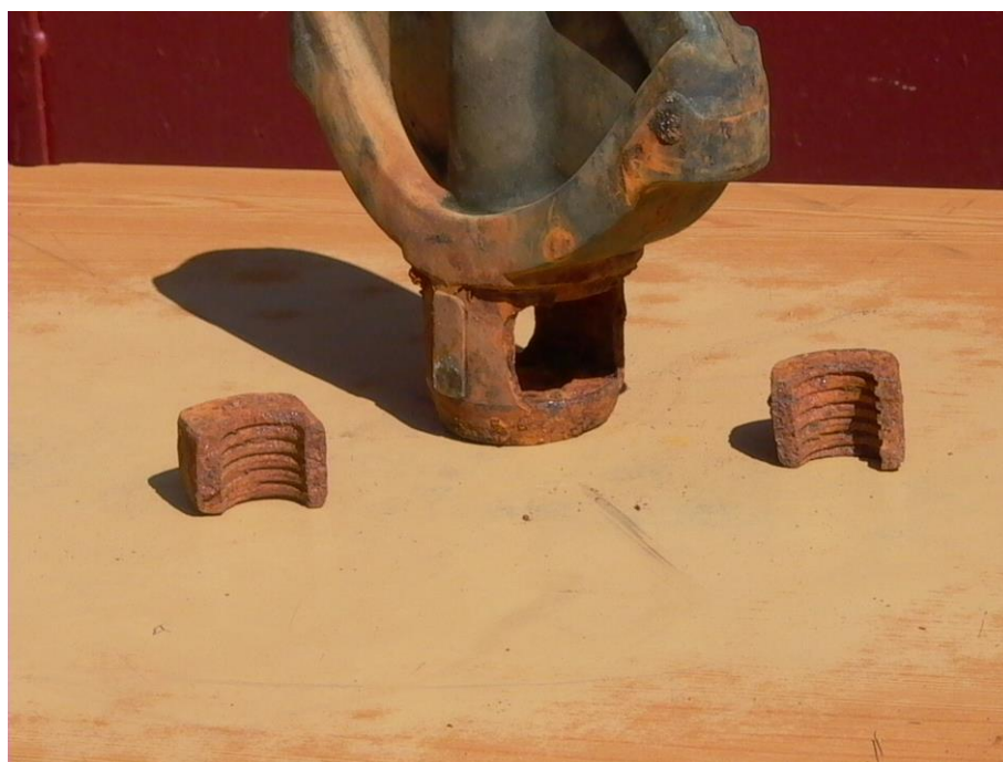
Рис. 1.2.2. Износ резьбы и разлом гайки
