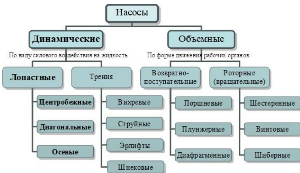
Рис. 1.4.1. Общая классификация насосов согласно ГОСТ 17398
