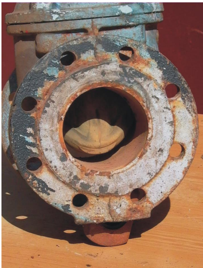
Рис. 1.2.7. Неполное перекрытие живого сечения из-за перекоса клина
