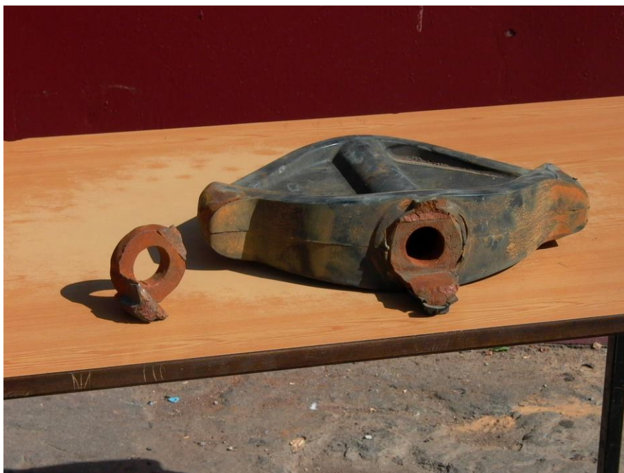
Рис. 1.2.1. Поломка стойки гнезда крепления гайки клина
