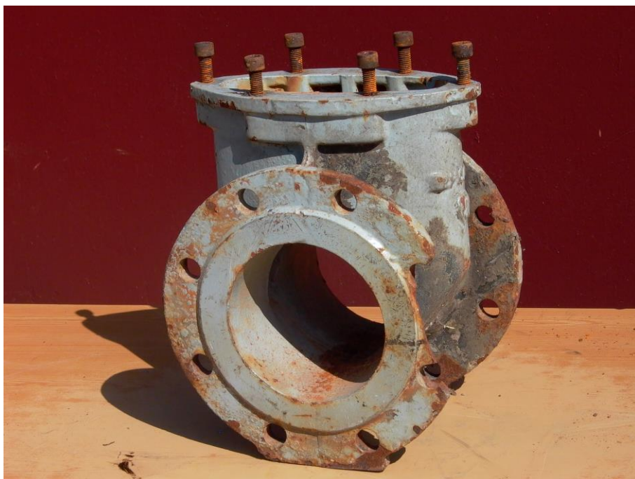
Рис. 1.2.5. Разрушение фланца, коррозия корпуса и болтов
