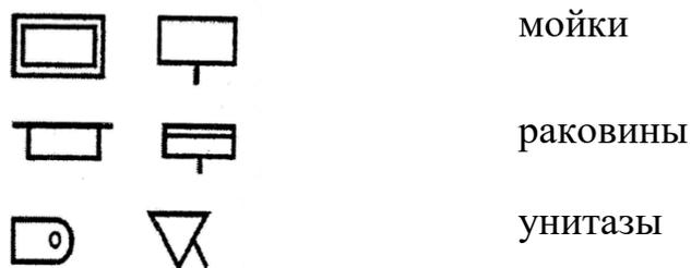
*Рис. 1. Санитарные приборы общего назначения*
