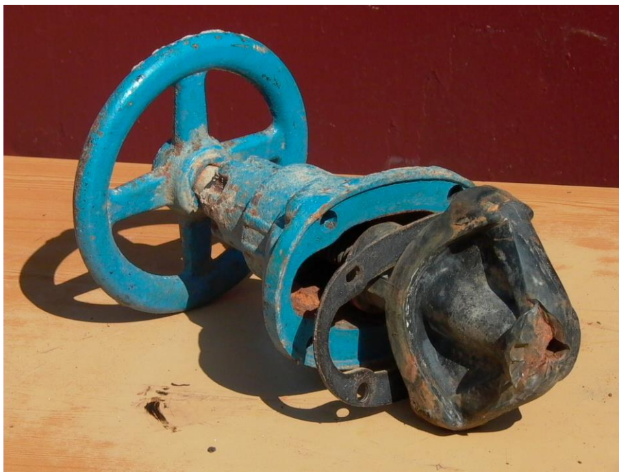
Рис. 1.2.3. Отслоение и разрушение резинового покрытия клина и отрыв резьбовой части корпуса клина
