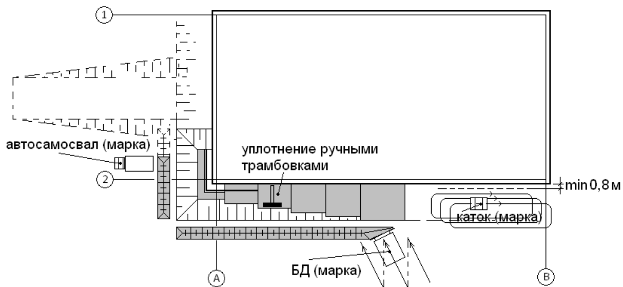
Рисунок 10. Схема обратной засыпки пазух котлована.
