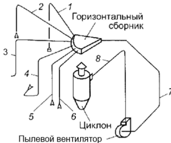
Рис.5-1 Аксонометрическая схема системы пневмотранспорта с центральным сборником отходов
