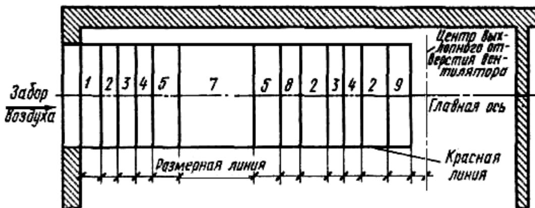
Рис.4.17. Примерная схема разбивки осей центрального кондиционера
