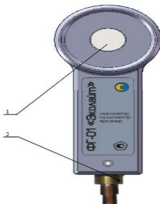
Рис. 4.1. Внешний вид ФГ-01 (лицевая сторона) 1 – рассеиватель; 2 – разъем для подсоединения кабеля к БОИ-01
