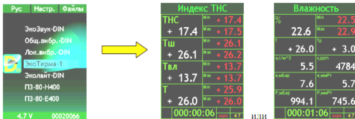
Рис. 3.3. Дисплей прибора ЭКОФИЗИКА-D для определения температуры и относительной влажности
