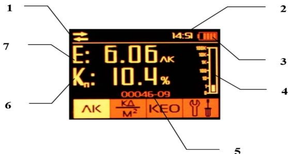
Рис. 4.3. Режим измерения освещенности и коэффициента пульсации
