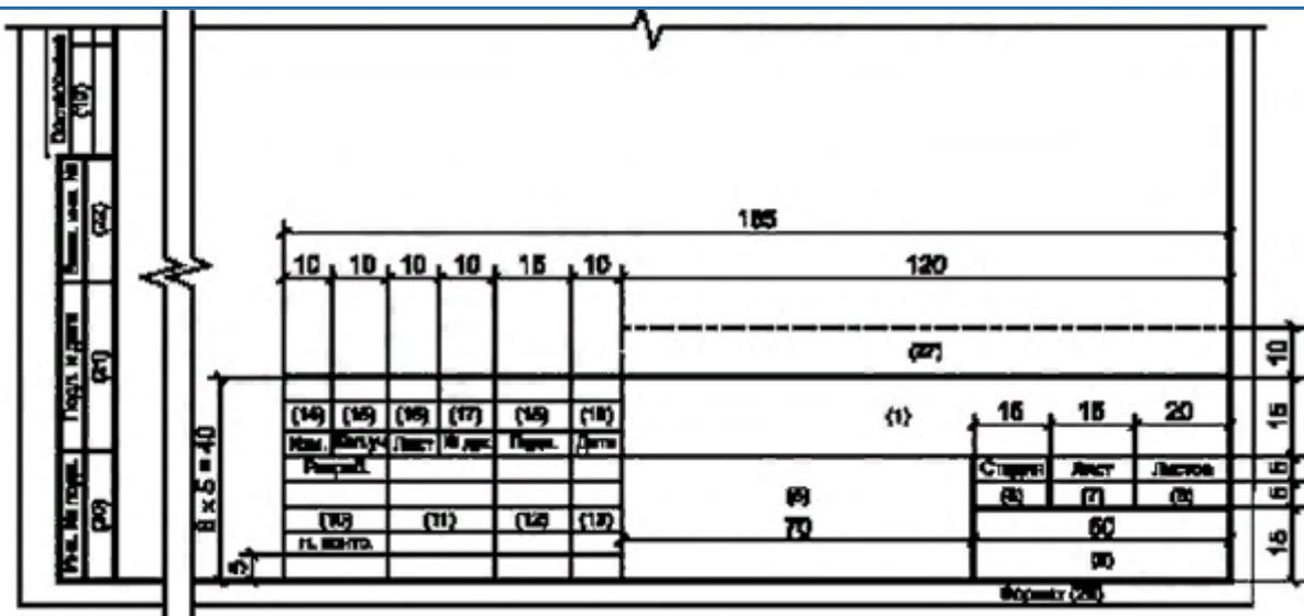
Примечание — Основную надпись по форме 5 допускается использовать для графических документов по инженерным изысканиям, не используемых в проектировании в качестве графической основы.
