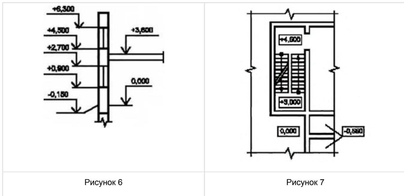
Нулевую отметку, принимаемую, как правило, для поверхности какого-либо элемента конструкций здания или сооружения, расположенного вблизи планировочной поверхности земли, указывают без знака; относительные отметки выше нулевой указывают со знаком «+», ниже нулевой — со знаком «-»\*.
