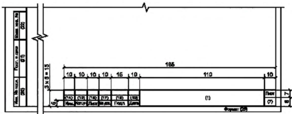
Примечание — Основную надпись по форме 6 допускается использовать для последующих листов графических документов по инженерным изысканиям, не используемых в проектировании в качестве графической основы.
