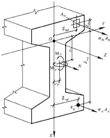
Рисунок 8.5 - Расчетная схема нормального сечения железобетонного элемента
