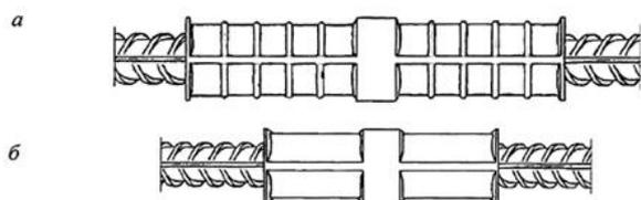
Рисунок Н.1 - Опрессованный стык построечного изготовления, произведенный на мобильном оборудовании многократным поперечным деформированием соединительной муфты с прожегутками (а) и без прожегуток (б)
