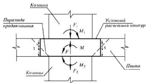
Рисунок 8.10 - Условная модель для расчета на продавливание
