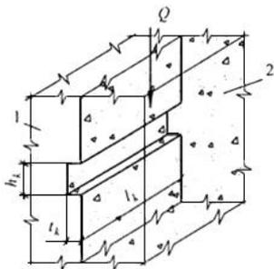
1 - сборный элемент; 2 - монолитный бетон
