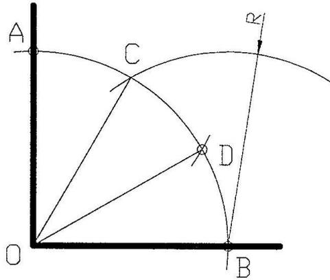
Рис.2.2.7. Деление прямого угла на три равные части
