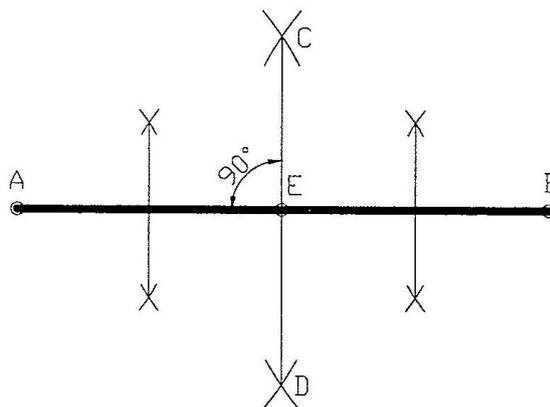
Рис.2.2.4. Деление отрезка на две и четыре части
