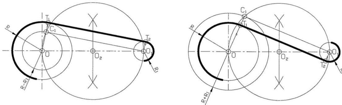
Рис.2.2.12. Построение внешней и внутренней касательных к окружности
