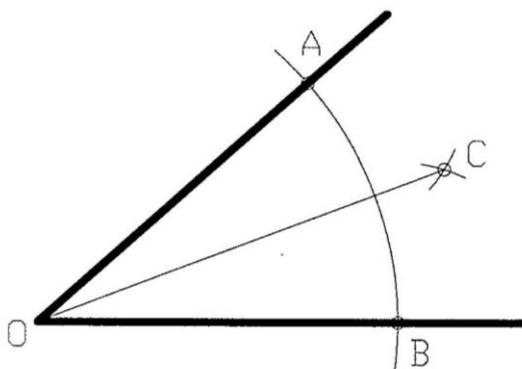
Рис.2.2.6. Деление угла на две равные части
