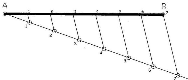
Рис.2.2.5. Деление отрезка на равные части
