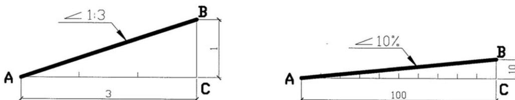
Рис.2.2.1. Построение и обозначение уклона
