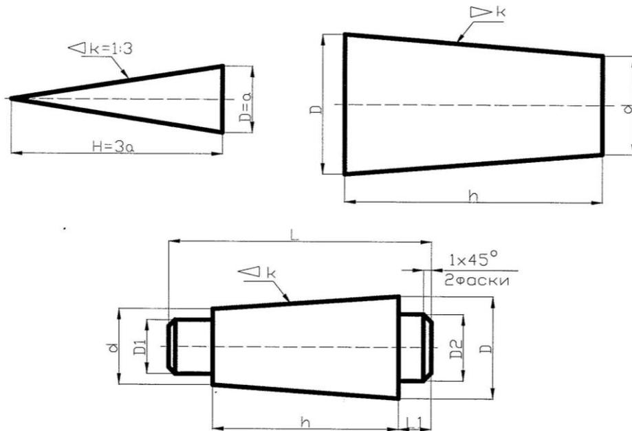
Рис.2.2.3. Построение и обозначение конусности
