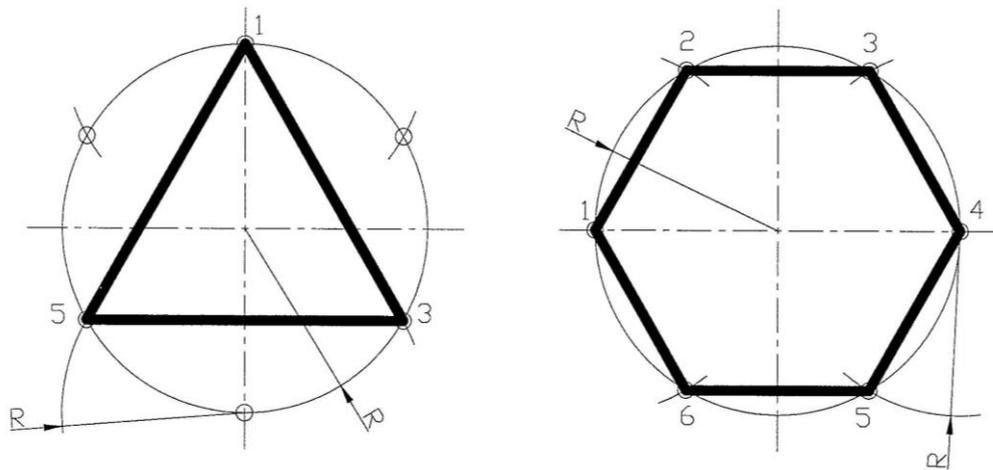
Рис.2.2.8. Построение равностороннего треугольника и правильного шестиугольника
