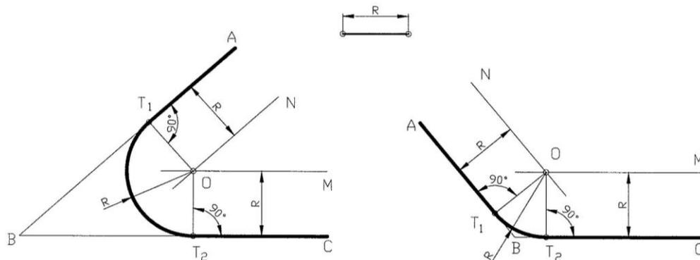
Рис.2.2.13. Сопряжение сторон углов
