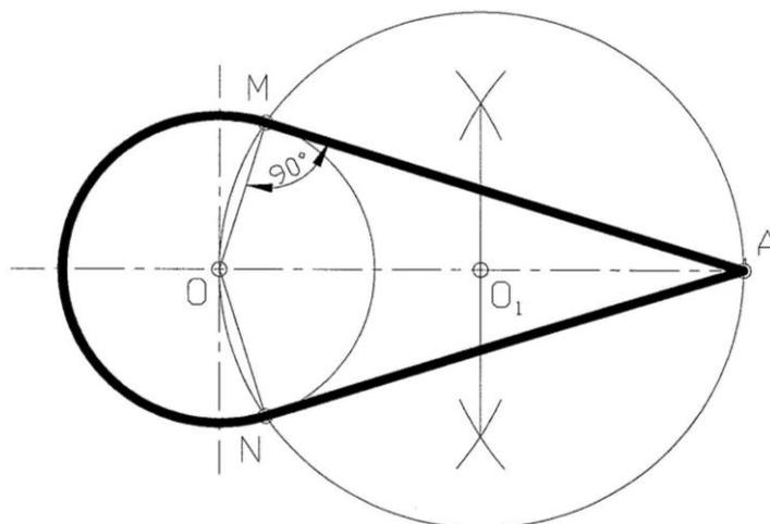
Рис.2.2.11. Построение касательной прямой из точки, лежащей вне окружности
