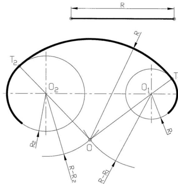
Рис.2.2.16. Внутреннее сопряжение двух дуг окружностей
