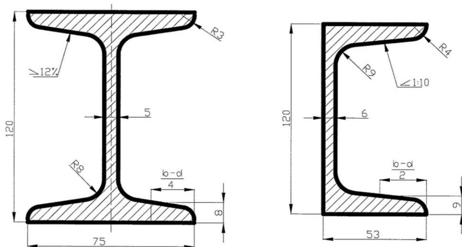
Рис.2.2.2. Пример использования уклона (двутавр и швеллер)
