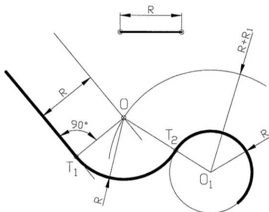
Рис.2.2.14. Сопряжение прямой линии с окружностью
