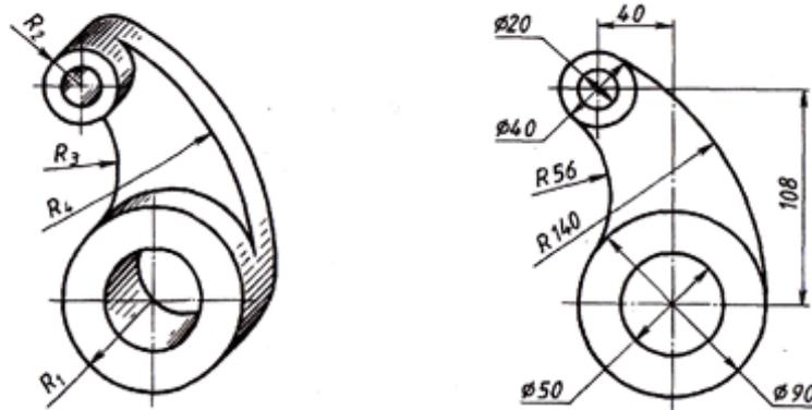
Рис.2.2.18. Пример применения сопряжений
