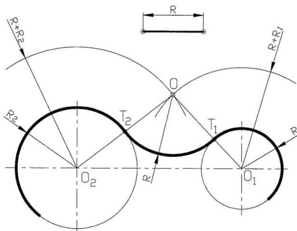
Рис.2.2.15. Внешнее сопряжение двух дуг окружностей
