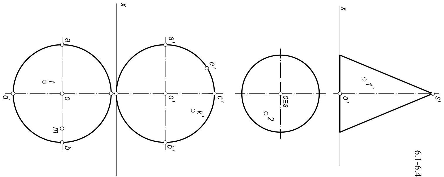
6.5. Построить очерток тора. Определить недостающую проекцию точки  $K$ , принадлежащей поверхности
